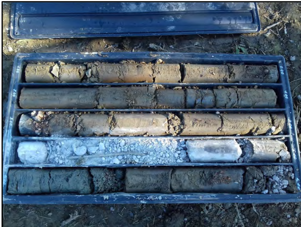
Fig. 25 - Sondaggio S2 (Parmageo s.r.l.) - Cassetta catalogatrice da 0 a 5 m – nell'intervallo 3,10 – 4,0 la carota è costituita da c.a.
