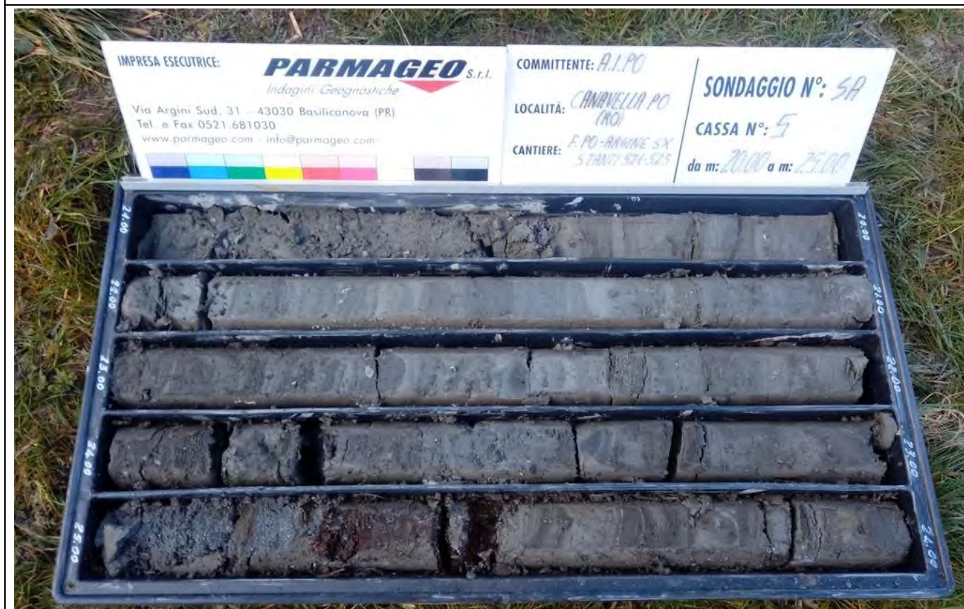
A.I.Po - Cavanella Po - Sondaggio SA - Cassa 5 (20.0 ÷ 25.0 m)
