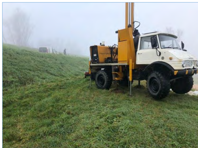
Foto 7 – Acquisizione dati SCPTU-1
