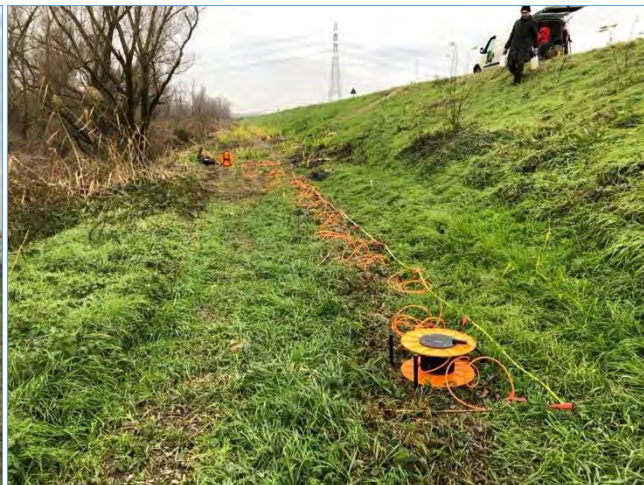
Foto 2 – Acquisizione dati ERT-L2
