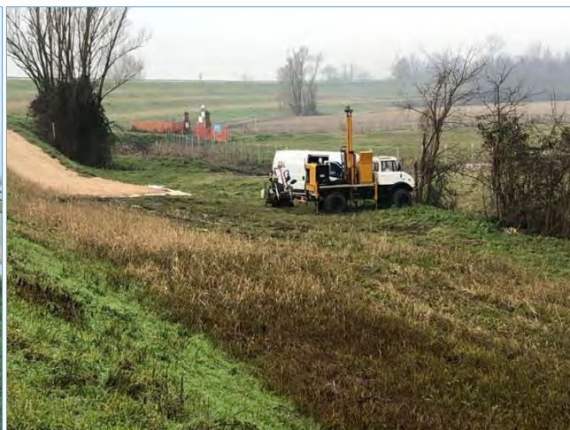
Foto 8 – Acquisizione dati CPTU-2
